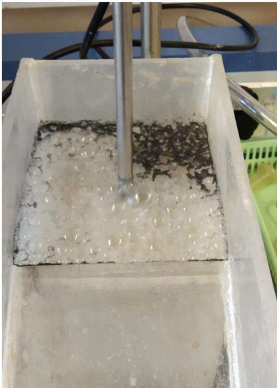
Рисунок 3.12 – Флотация запечатанной бумаги «SvetoCopy ECO» в лабораторных условиях
