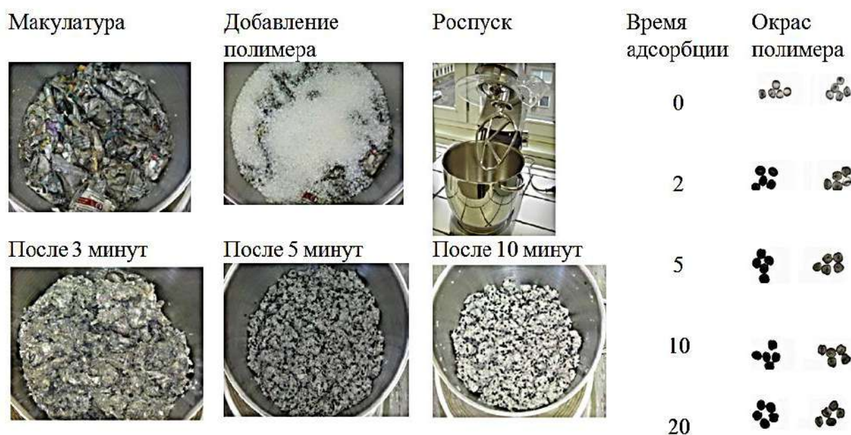
Рисунок 1.14 – Использование полимеров для адсорбционного деинкинга макулатурной массы [33, 83]
