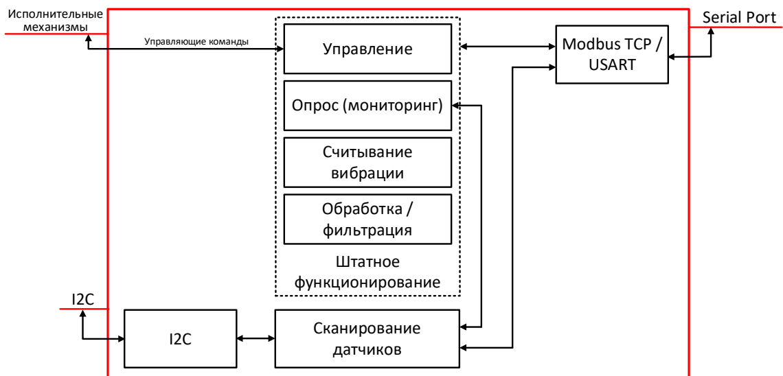
Рисунок 2 – Структура ПО модуля связи трехосевого акселерометра с информационным блоком
